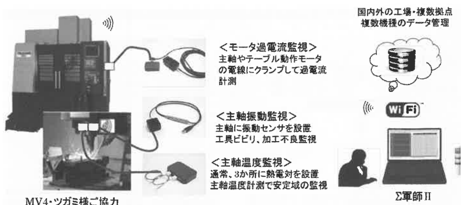
図4 工作機械の「主軸モニタリン」とデータ分析システム「Σ軍師II」
