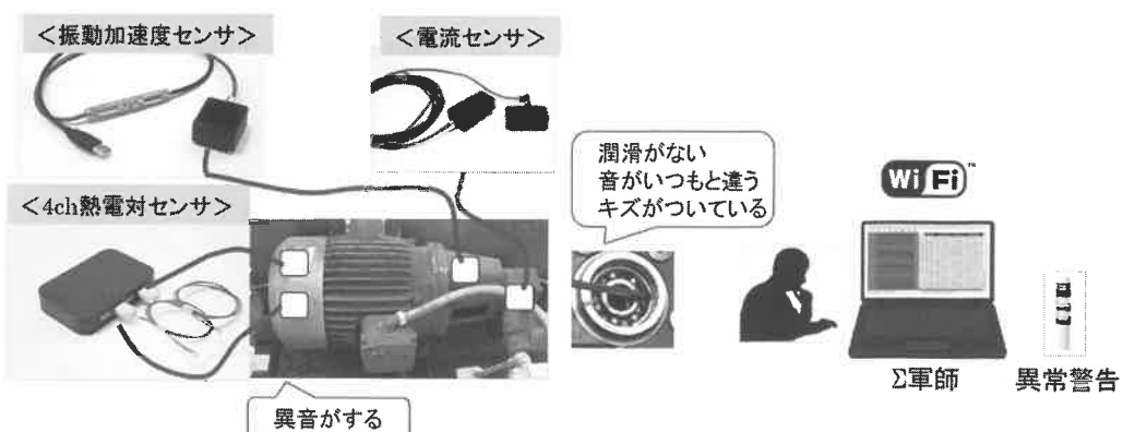
図3 「Stethoscope II」：無線式温度・振動・電流センサによるハイブリッド異常監視システム
