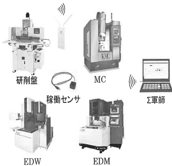
図4 「Stethoscope II」稼働モニタリン（振動・加速度）による各種工作機械の稼働監視システム
