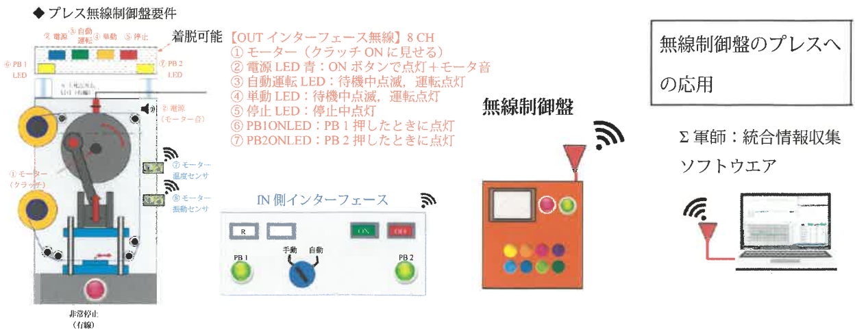
図 28 プレス機への無線制御盤取付け+情報収集の概要図
