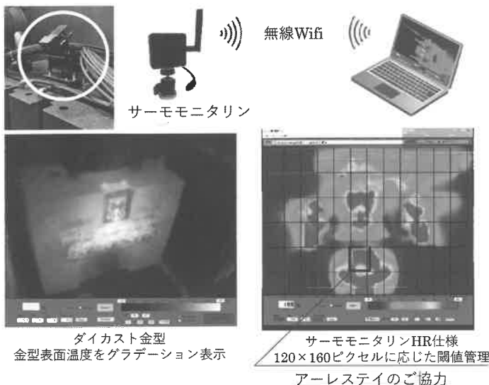
図9 無線金型表面温度センシングシステム「サーモモニタリン」
