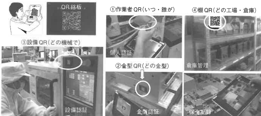
写真1 QRコードとタブレットによる金型棚卸・所在管理・保全記録のデジタル化
