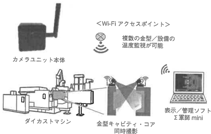
図2 「サーモモニタリン」のシステム構成(左)と諸元表
