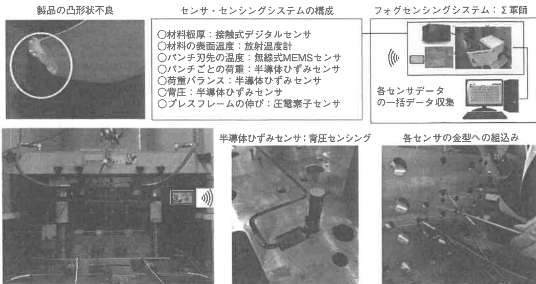
図10 フォグコンピューティング金型監視システム
