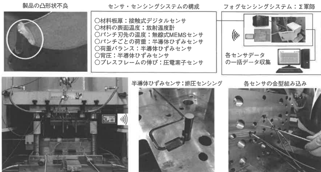
図 10 フォグコンピューティング金型監視システム
