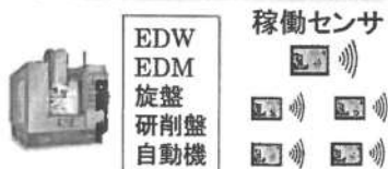
図5 振動加速度式稼働センサによる工作機械の「稼働モニタリン」
